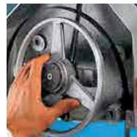
Sistema brevettato estrazione e supporto puleggia Patented pulley support removing system
