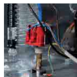
Pompa immissione umidità Humidity injection pump
