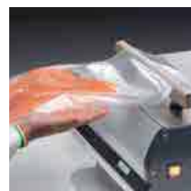
Utilizzo di buste goffrate per il vuoto fuori campana Embossed bags can be used to seal bigger products holding them outside the lid
