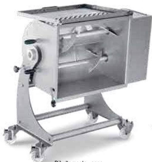
Ribaltamento vasca Tank overturn
